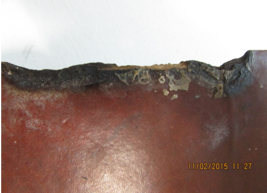
الصورة 140 : آثار الحرق وتقوس بالدفة السفلى
