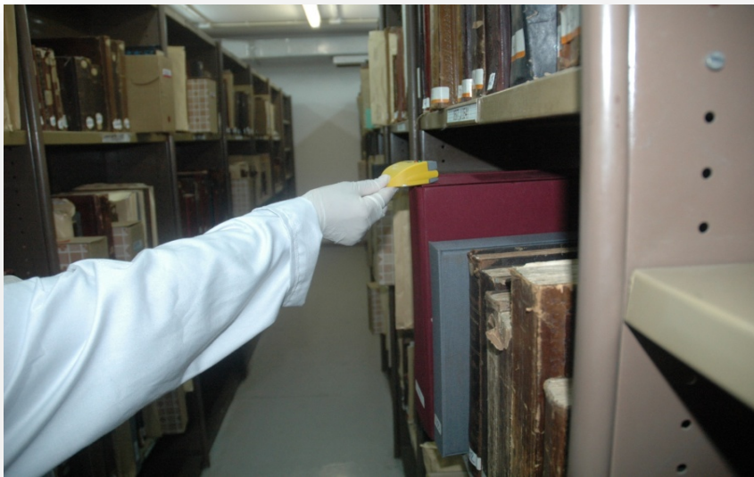
الصورة 64 : تثبيت جهاز قياس الحرارة والرطوبة Tinytag داخل المخزن
