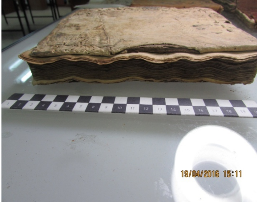
الصورة 28 : اعوجاج الورق والجلود بعد امتصاص الماء
