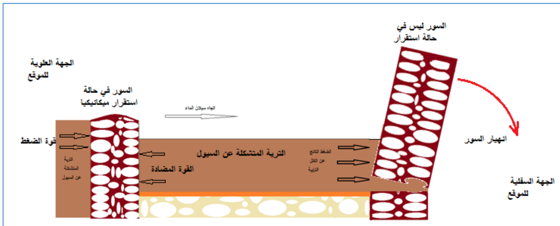
المخطط رقم 25: رسم تخطيطي لظاهرة تلف الاسوار بفعل السيول
