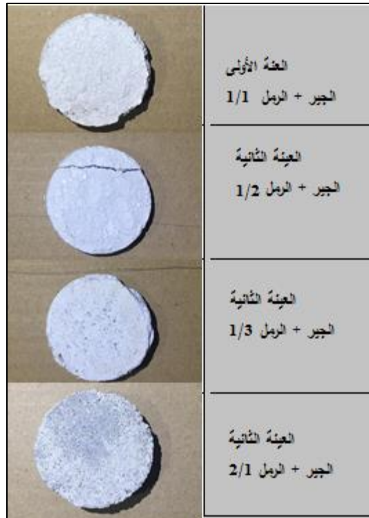
الصورة رقم 119: تظهر عينات طبقات الملاط التجريبية في الفترة الممتدة من أكتوبر 2016 - أوت 2017
