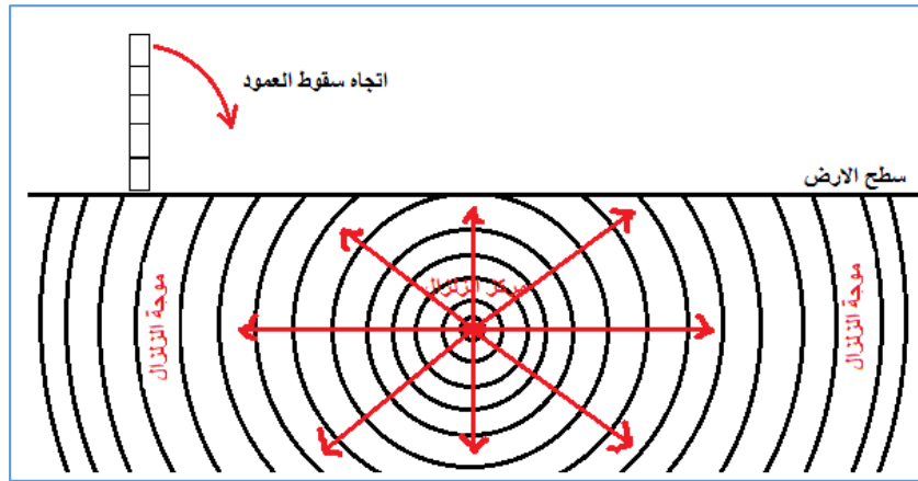
المخطط رقم 24: يوضح انتقال موجات الزلزال
