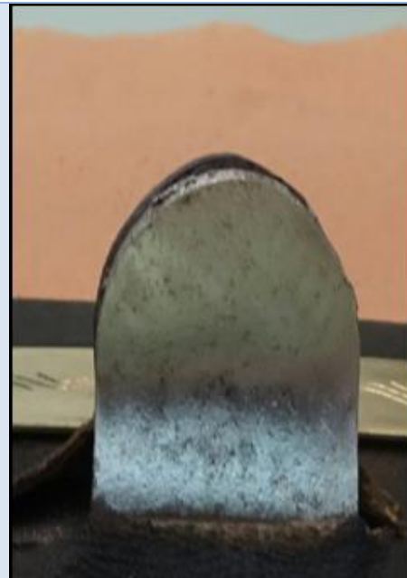
الصورة رقم 99: التنظيف بالمرملة
