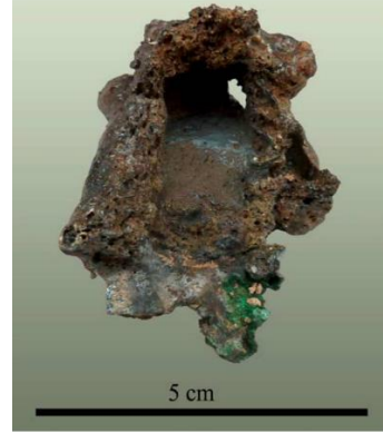
الصور رقم 67 و 68: تأكل الكلفاني، بإفراز النحاس او سبائككه اللون الأخضر على القطع الحديدية
