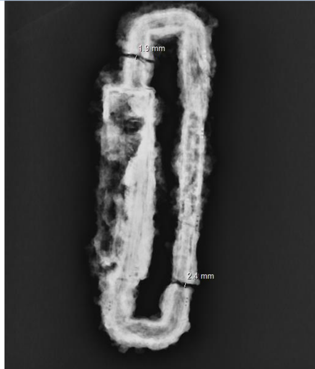
الصورة رقم 87: صورة بالأشعة السينية، تشقق عرضي فصل اللقي الى قسمين.
