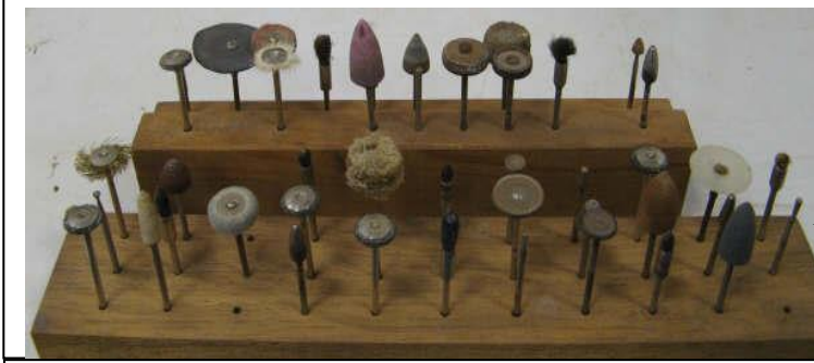
الصورة رقم 127: مختلف انواع الابر للمثقب الالي
