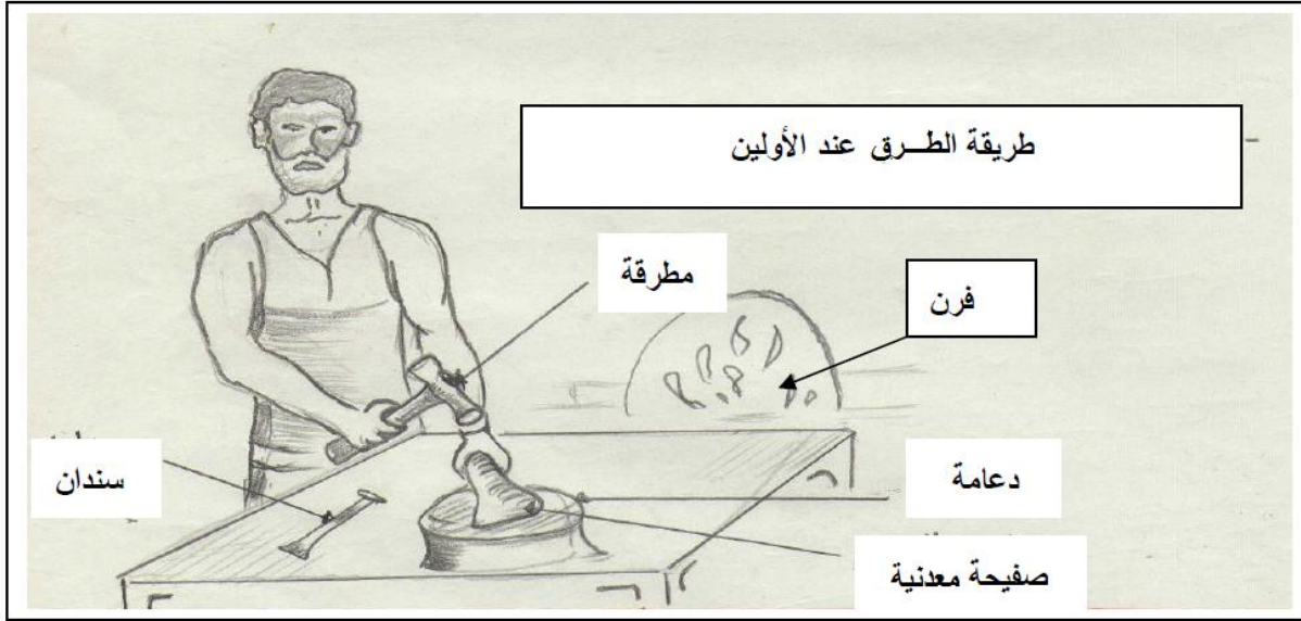
الصورة رقم 50: طريقة الطرق، عن نبيل امقران، المرجع السابق ص 31 ، بتصرف.
