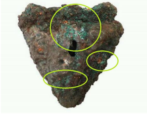
الصور رقم 67 و 68: تأكل الكلفاني، بإفراز النحاس او سبائككه اللون الأخضر على القطع الحديدية
