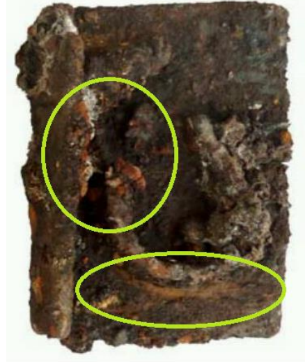
الصورة رقم 73 و 74: اللون البني المائل الى البرتقالي) تأكسد الحديد
