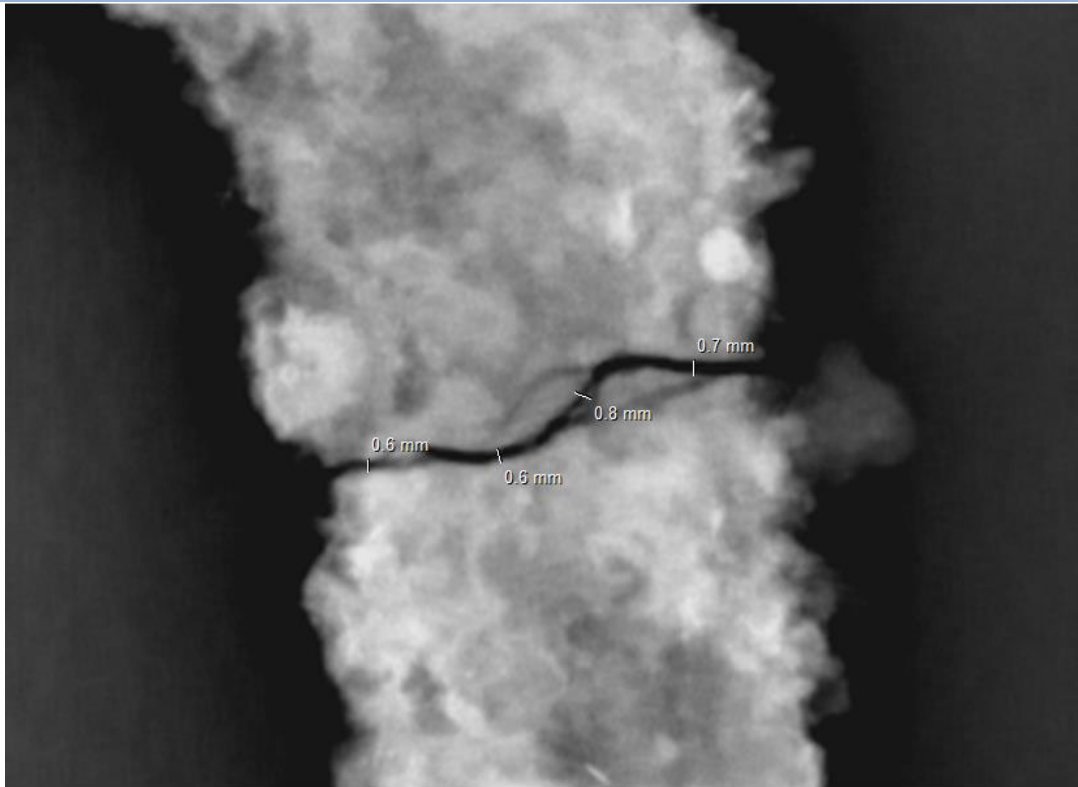
الصورة رقم 89: صورة بالأشعة السينية، شق منحرف في عمق اللقي الحديدية.
