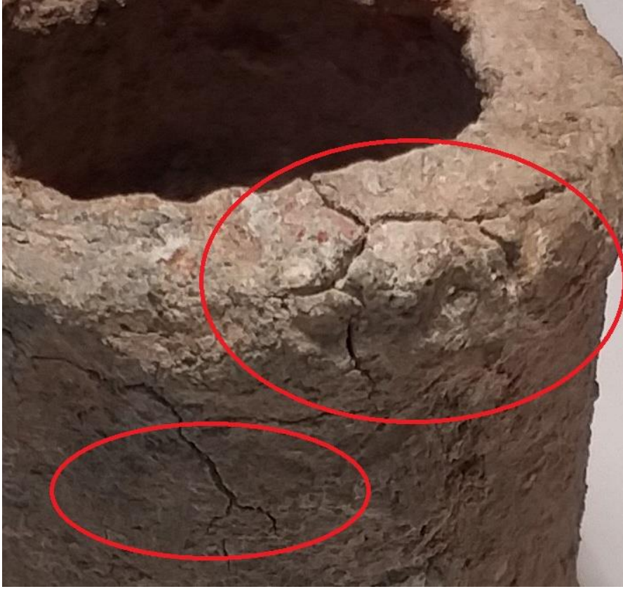
الصورة رقم 71: تشقق القطعة المعدنية الرصاصية وبداية تقشرها.
