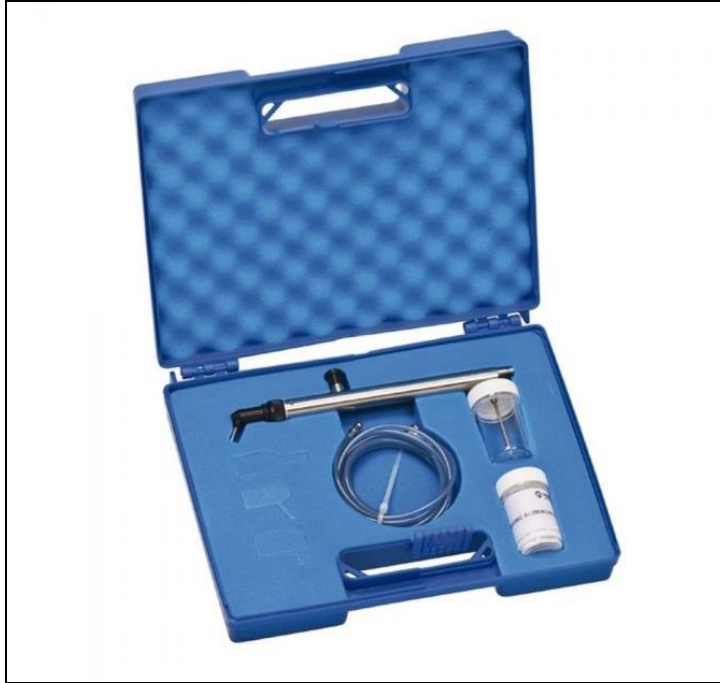
الصورة رقم 95: المرملة micro sableuse.
