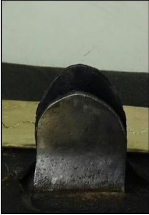
الصورة رقم 102: التنظيف بالسلك الفولاذي
