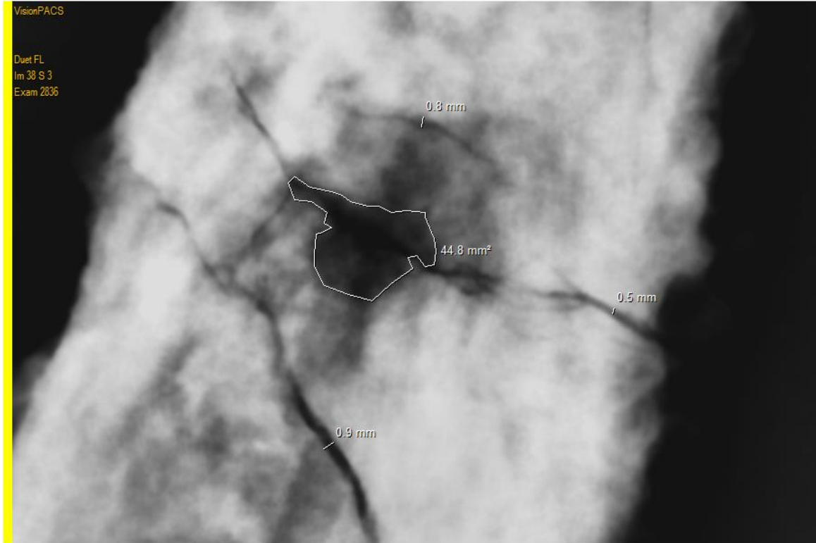
الصورة رقم 86: صورة بالأشعة السينية، تشققات شبكية مشكلة فراغ في وسط اللقي.
