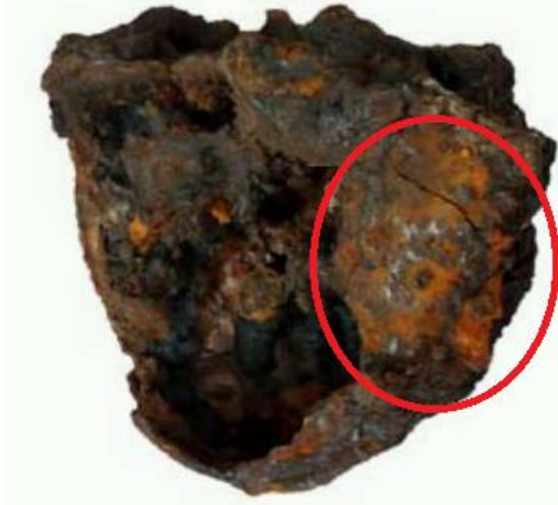
الصورة رقم 73 و 74: اللون البني المائل الى البرتقالي) تأكسد الحديد
