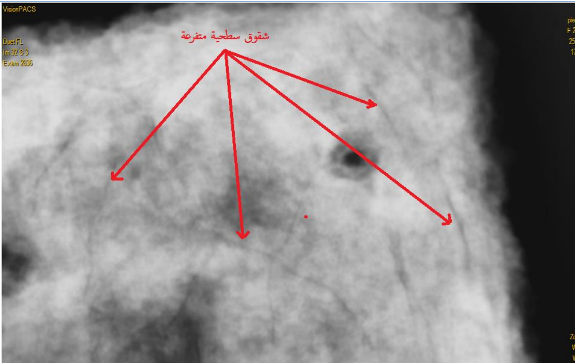
الصورة رقم 91: صورة بالأشعة السينية، شقوق سطحية متفرعة.
