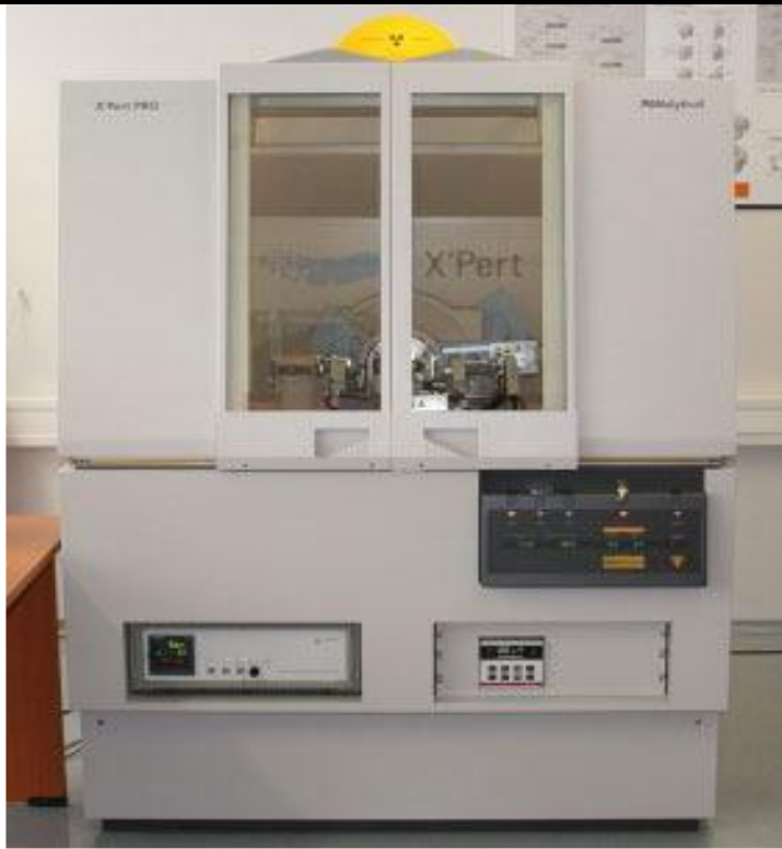
الصورة رقم 17: جهاز حيود الأشعة السينية X'pert PRO Panalytical
