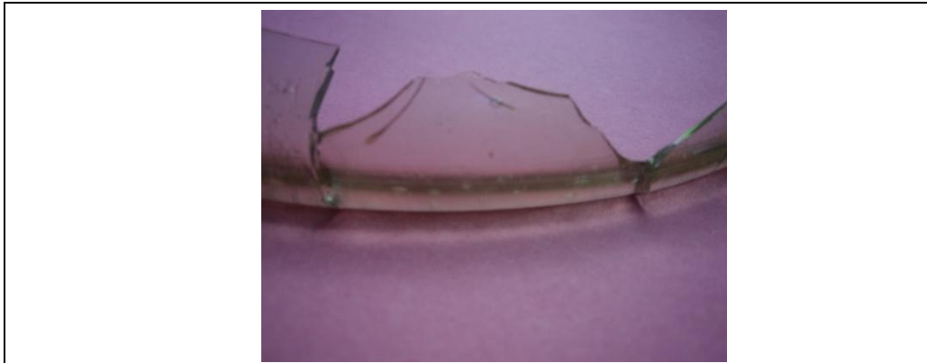
الصورة 56: مظهر القطع بعد جفاف اللاصق
