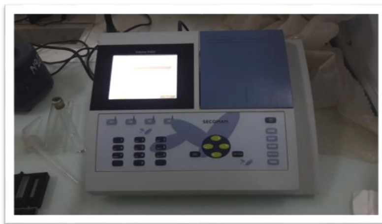
الصورة رقم: 11 تمثل جهاز الطيف الضوئي (spectrophotomètre)
