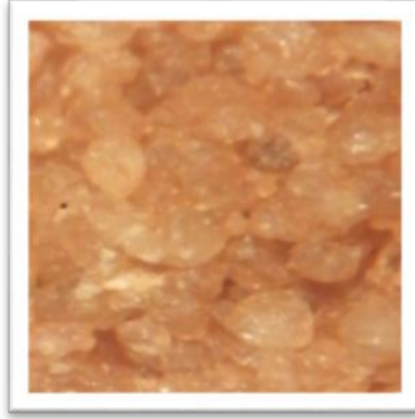
(صورة رقم 17: تمثل ملاحظة عينات الحجر الرملي بالمجهر الضوئي)
