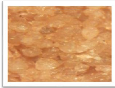
صورة رقم 19: تمثل ملاحظة عينات الحجر الرملي بالمجهر الضوئي
