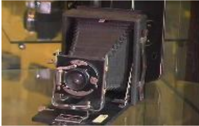
الصورة 38: واحدة من أولى آلات التصوير بلوحة و منفاخ "Appareil photo à plaque et à soufflet"
