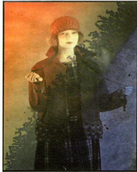
الصورة 136: تلف لوحة الأوتوكروم بسبب الماء، صورة خاصة بالأزياء، حوالي عام 1920م. عن: Lavédrine (B.) , 2007, p.89.
