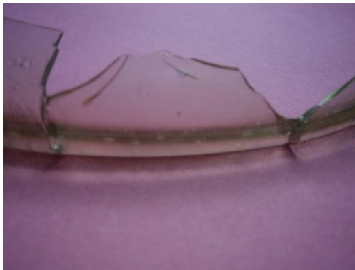
الصورة 109: مظهر القطع بعد جفاف اللاصق
