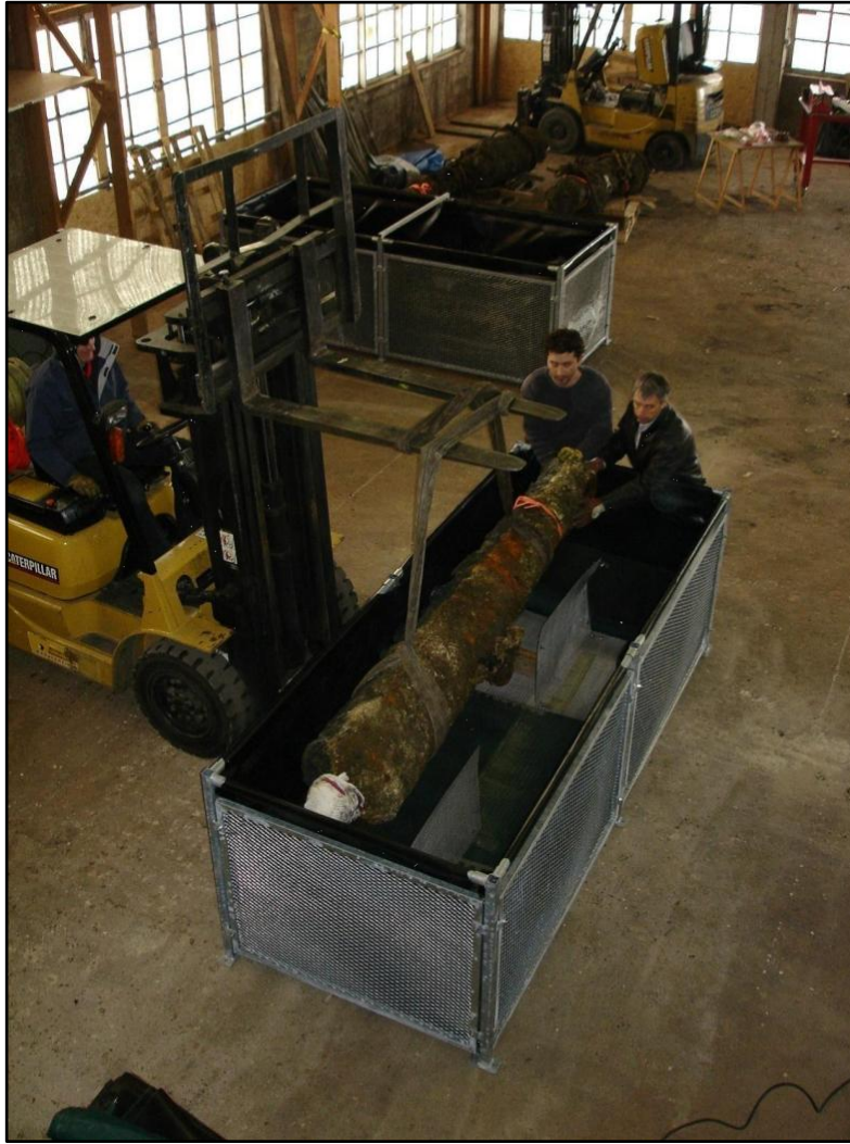
الصورة رقم 55 : مثال عن الحوض المستعمل في عملية التحلل الكهربائي عن مخبر A-Corros
