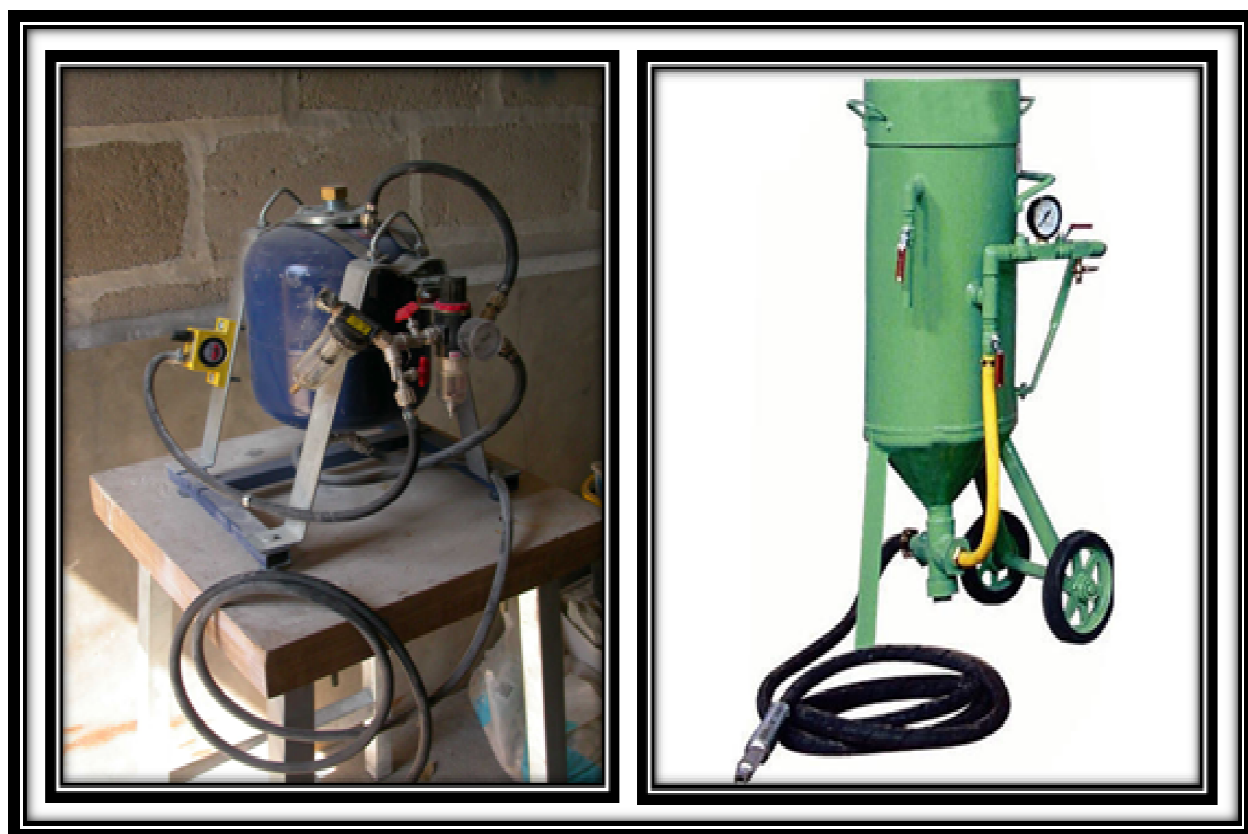
صورة (14) جهاز الدفع بواسطة حبيبات الرمل.
