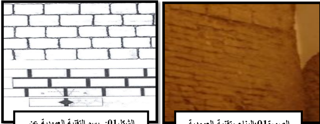
الشكل 01: رسم التقنية العمودية عن
