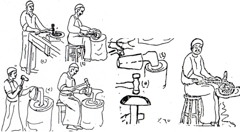
شكل 7- عملية الطرق و ما يتبعها من عمليات كالتقريب و التعميق و غيرها
