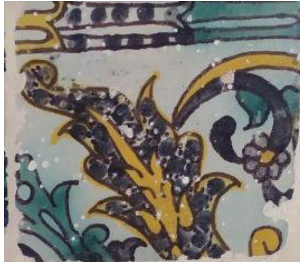
الصورة رقم 30: الثقوب على مستوى المربعات الخزفية
