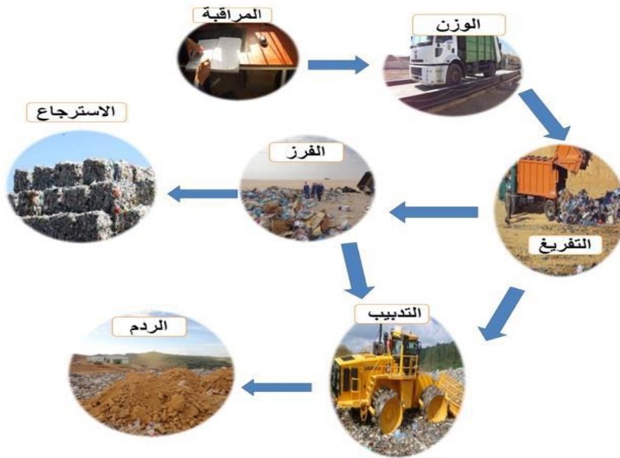
صورة رقم (03) يمثل مراحل معالجة النفايات بمراكز الردم التقني (بولعراس نور الدين، محاد مومنة (2020) ص 147)
