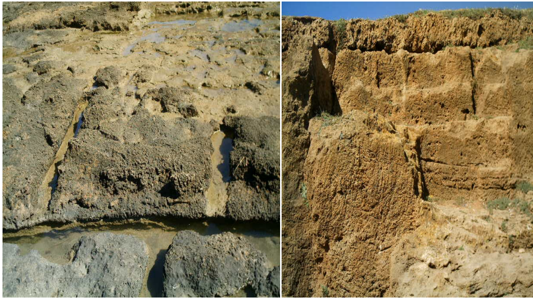
( الصور رقم 65 - 66 ) آثار استغلال الحجارة الرملية في محجرة " بتي فيشي " .
