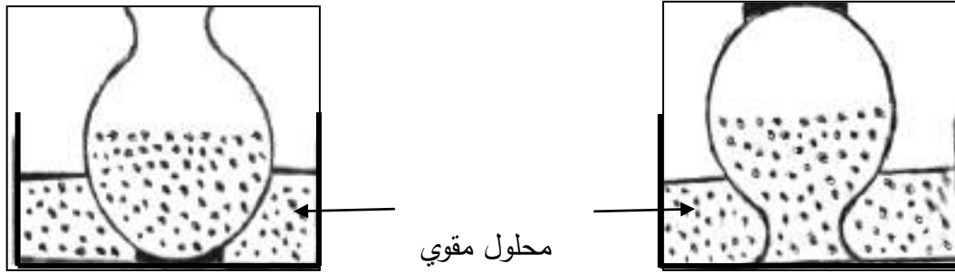
شكل 12: التقوية بالغمر الجزئي (عن باريكو ص: 122)
