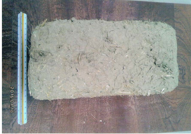
الصورة رقم (40): الطوب المستعمل في بناء جدران المساكن
