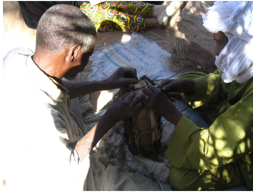
الصورة رقم 23 مرحلة خياطة الجلود وشدّها إلى الأطار الخشبي بشرائط جلدية
