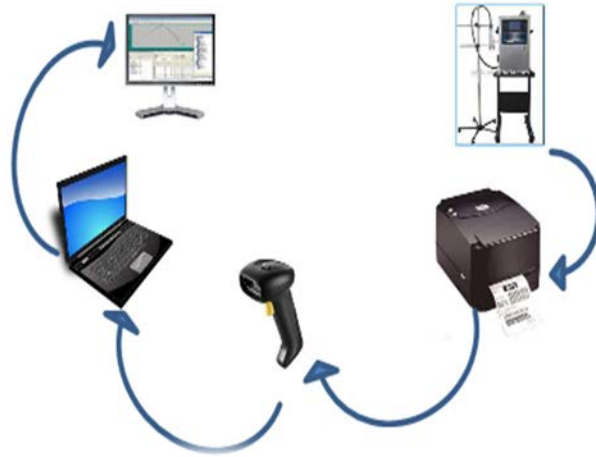
الشكل رقم (05): يمثل مكونات نظام الباركود. 34
