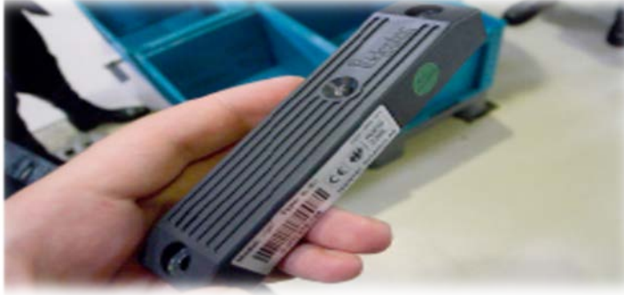
الشكل رقم(14): يمثل رقاقة فعالة Active Tag.
