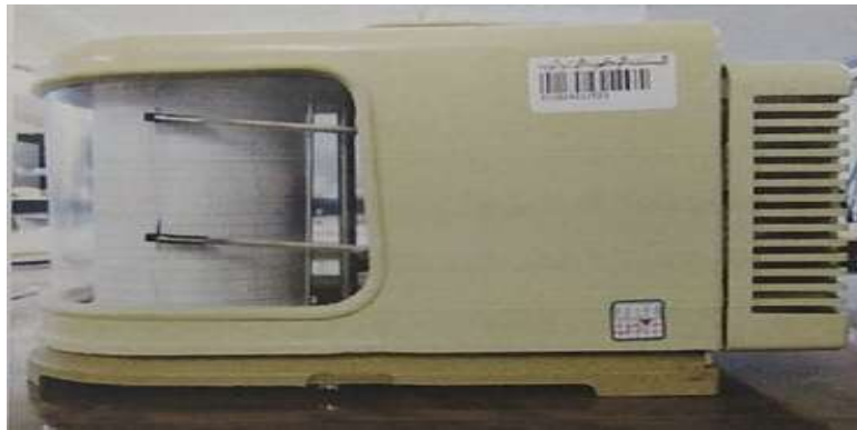
الشكل رقم (15) يمثل جهاز thermo- hygromètre- a band لقياس الرطوبة والحرارة. 2
