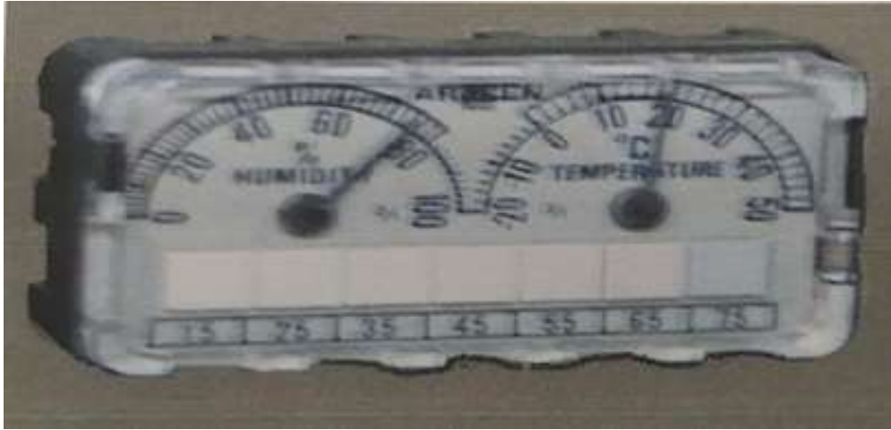
الشكل رقم (16) يمثل جهاز mini-thermo-hygromètre لقياس الرطوبة والحرارة. 1
