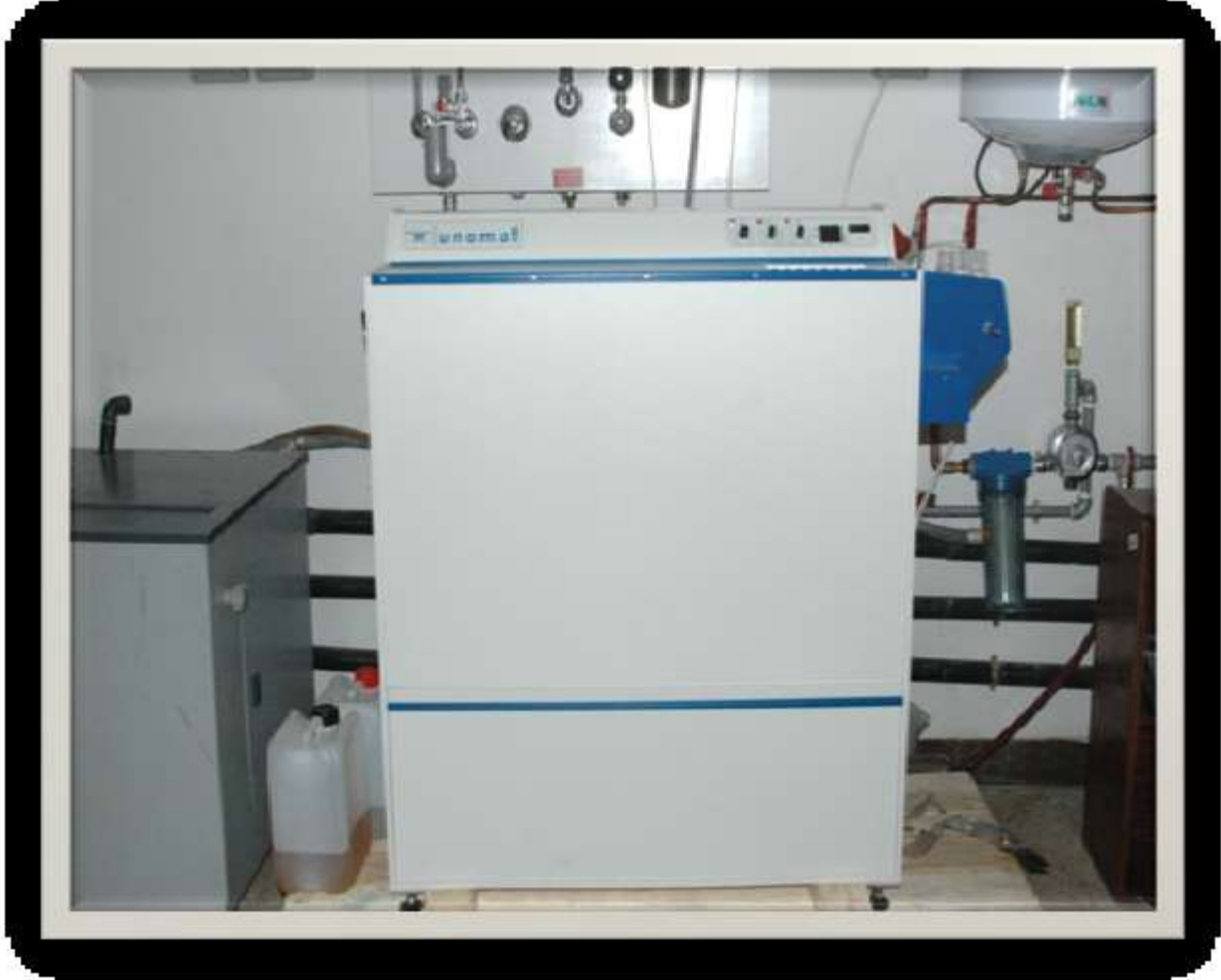
الشكل رقم (09) يمثل مطورة الفيلم بمصلحة التصوير. 1
