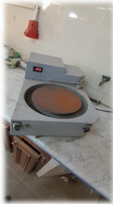
الصورة رقم 36 : جهاز لفرك العينة بعد نزعها من الصفيحة الساخنة لتشكيل الطبقة الرقيقة على الشريحة الزجاجية للملاحظة بالمجهر، من إعداد الطالبة
