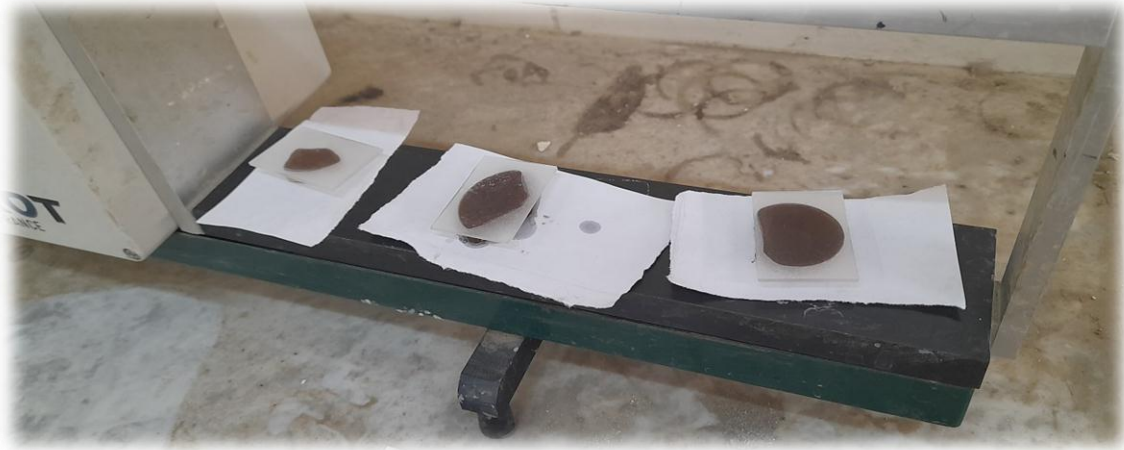
الصورة رقم 35 : العينات بعد الصاقها بواسطة غراء خاص على الشريحة الزجاجية وتسخينها، من إعداد الطالبة
