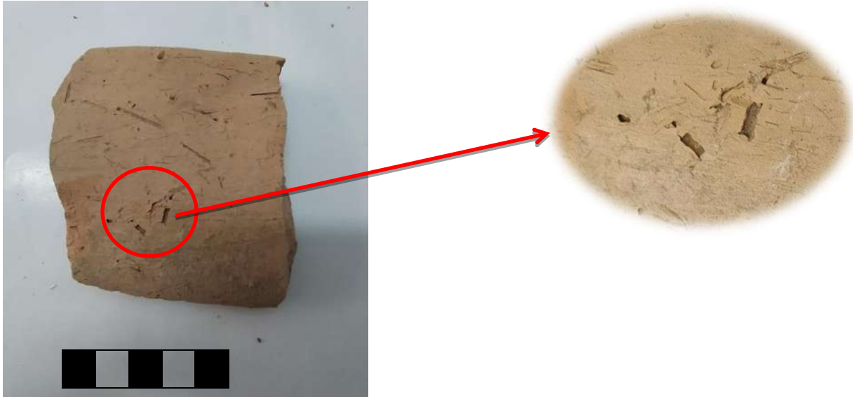
الصورة رقم(19): تبين التجاويف الظاهرة على السطح(بتصرف الطالبة).
