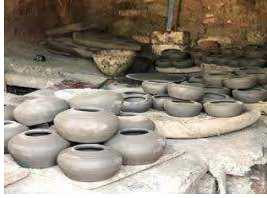
الصورة رقم(06): توضح تجفيف الفخار بعد التشكيل. (عن صفوت نور الدين)
