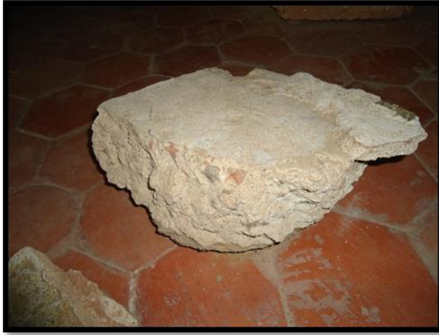
الصورة رقم 121: عينة من الطابية المستعملة داخل القلعة
