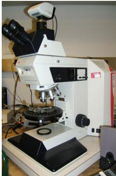
الصورة رقم 04 مجهر بتر وجرافي (مجهر مستقطب) المستخدم في فحص الخصائص البصرية للمعادن
