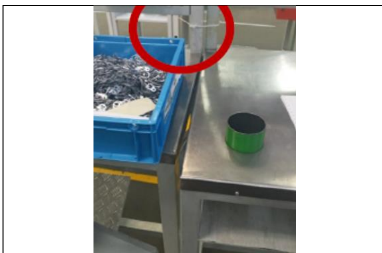
Figure 5 : Mauvaise fixation des tables : Vibration lors de l'assemblage
