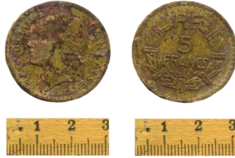
الصورة 66: التآكل بين الحبيبات
