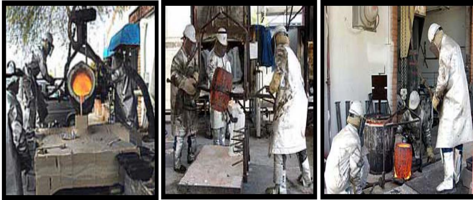
الصور رقم 46، 47، 48: مراحل صهر المعدن في البوتقة وصبه في القوالب. 2
