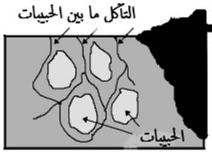
الشكل 08: التآكل بين الحبيبات عن
