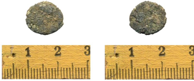
الصورة 62: التآكل الجاف أو الكيميائي - عن عزالدين بويحيوي-
