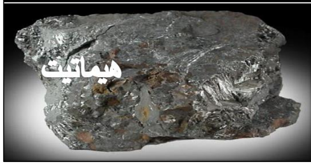
الصورة 43: معدن الحديد في شكل خام الهيماتيت
