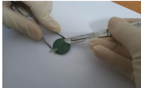
إزالة طبقة شمع النحل بواسطة المشرب
