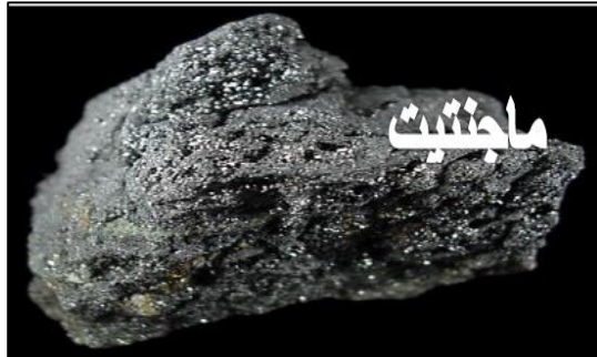
الصورة 44: معدن الحديد في شكل خام الماجنتيت، عن عماد محمد إبراهيم خليل 3
