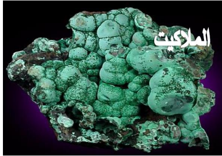
الصورة 42: معدن النحاس في شكل خام الملاكييت
