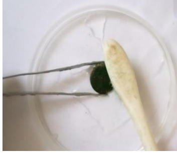
التنظيف بالماء المقطر وفرشاة الأسنان.
