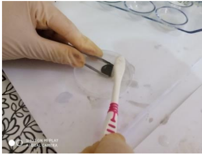
التنظيف بالماء المقطر وفرشاة الأسنان.
