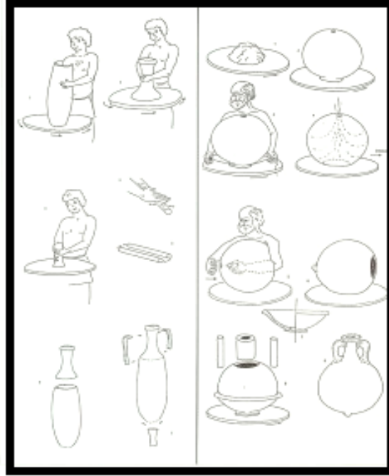
الشكل: (01): يوضح مراحل صناعة الأمفورات. (2)
