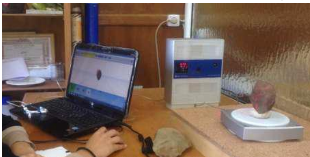
الشكل 59. كيفية مسح الأداة بجهاز المسح الضوئي الثلاثي الأبعاد (NextEngine).
