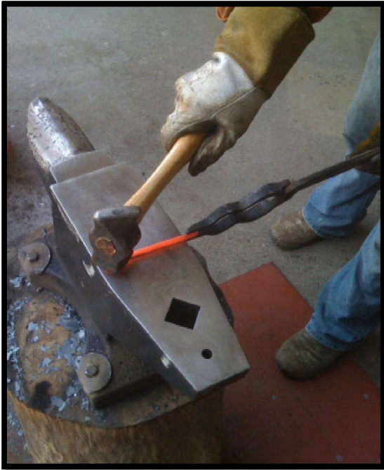
الصورة رقم : 22- الطرق الساخن
