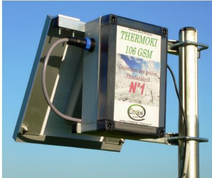
الصورة رقم 110: تبين جهاز إنذار الجليد من نوع THERMOKI-106-GSM (1) .
