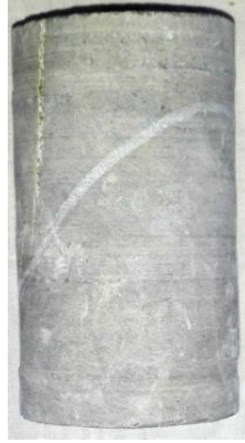
الصورة رقم 92: عينة الحجارة الكلسية البنية الصلبة (1ع)
