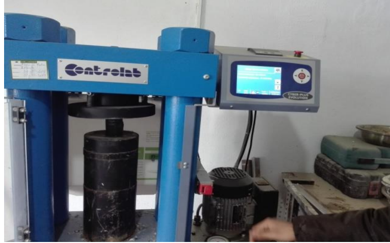
الصورة رقم 98: تبين الجهاز المستخدم في قياس مقاومة الضّغط من نوع Controlab
