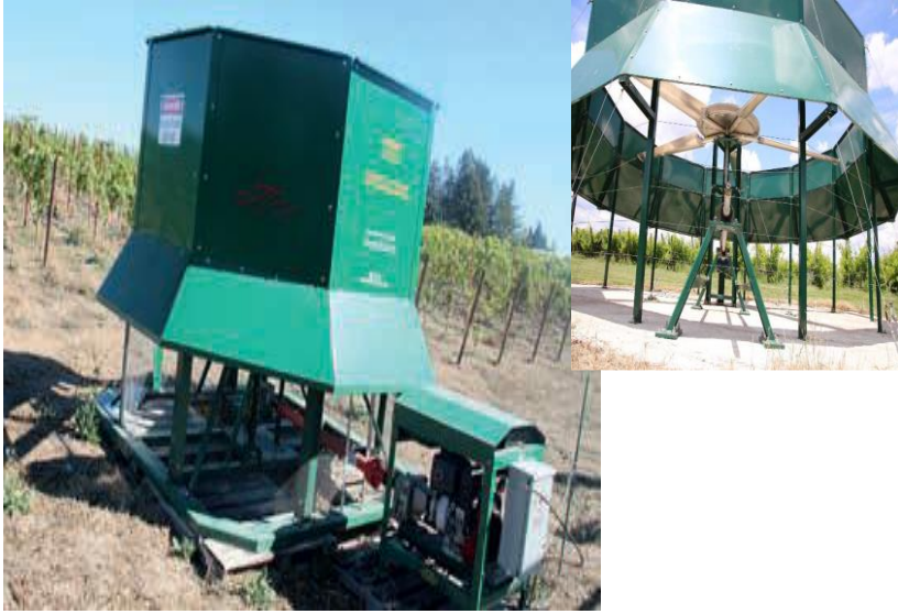
الصورة رقم 112: تبين جهاز استخراج الهواء البارد (1)
