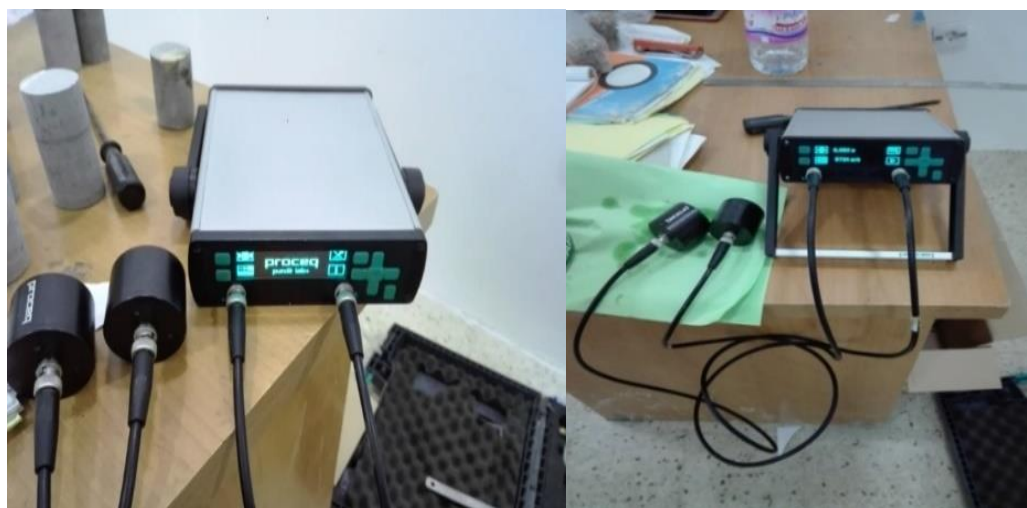
الصورة رقم 97: تبين جهاز قياس سرعة الموجة فوق الصوتية
