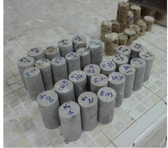
الصورة رقم 100: تبين عينات الإختبار المحضرة لدورات التجميد والذوبان الصورة رقم 101: تبين غرفة التجمد والذوبان
