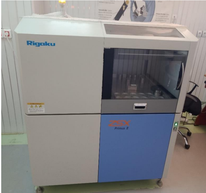
الصورة رقم 95: تبين جهاز فلورة الأشعة السينية من نوع «ZSX Primus II Rigaku» وجهاز سحق العينات
