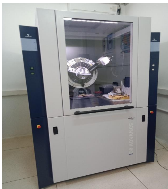
الصورة رقم 96: تبيين جهاز حيود الأشعة السينية D8 advance Diffractometre
