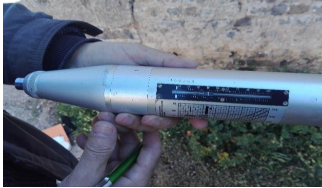
الصورة رقم 99: تبين جهاز قياس مؤشر الصلابة السكليرومتر
