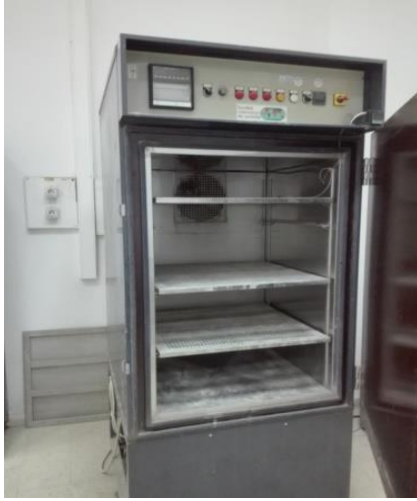
الصورة رقم 100: تبين عينات الإختبار المحضرة لدورات التجميد والذوبان الصورة رقم 101: تبين غرفة التجمد والذوبان
