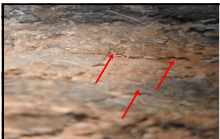
الصورة 38: صورة ميكروسكوبية للعينة HMN-13-10 تبين تشققات دقيقة تفوق 1ملم بالأحمر-
