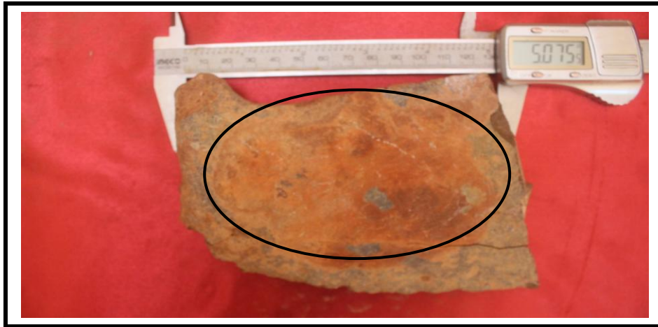
صورة 36 : آثار أكسدة على إحدى عينات الدراسة (صفيحة جلدية) - عن الطالب-
