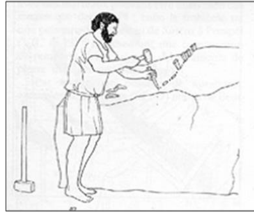
01- طريقة إحداث الصدع لقطع الحجر
