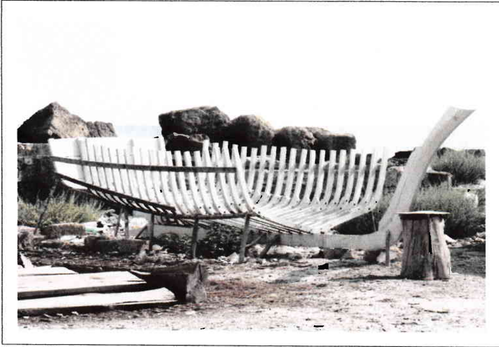
الصورة رقم (01): صورة لهيكل سفينة لبنانية، ولا يزال الصيادون يستعملون نفس التقنيات الفينيقية القديمة في بناء السفن.
