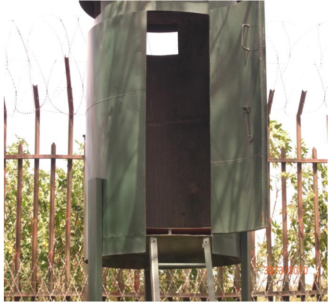
الصورة (28): الناحية المركزية (براقي): نافذة الرؤية جدّ ضيقة حيث لا يستطيع العامل فيها رؤية ما يوجد في المحيط الخارجي
