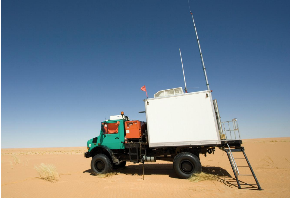
الشكل 26: الشاحنة الإهتزازية التي تقوم بالتقاط البيانات المسجلة من طرف جهاز الإستشعار، لتطرح بعدها لبيانات رقمية و يتم تحويلها لمخيم القاعدة. ( base de camp ).
