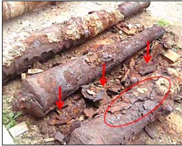
الصورة رقم 07 : تبين التشققات والتفتت في السطح الخارجي نتيجة التفاوت في درجات الحرارة و الرطوبة بالإضافة لتغير الوسط الخاص بالمتحف
