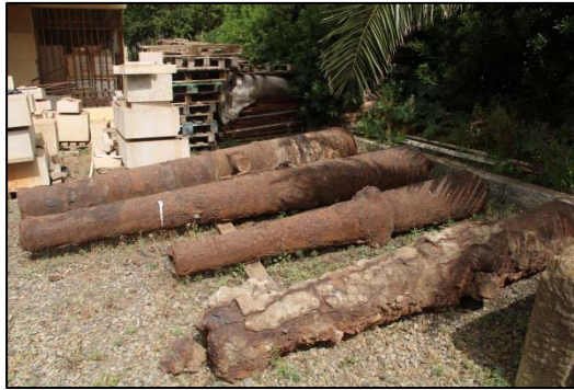
الصورة رقم 06: يظهر اللون البني الغامق على محيط المدافع وبقع سوداء، بالإضافة الى تفتت الجزء الخارجي للمدافع بشكل كبير. سنة 2022
