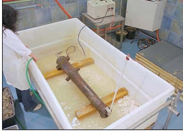
الصورة رقم 08 : توضح عملية وضع مدفع داخل حوض او حمام مائي وربطه بدارة كهربائية من اجل عملية التحليل الكهربائي عن دليل معالجة وصيانة المكتشفات الأثرية منشور اليونسكو
