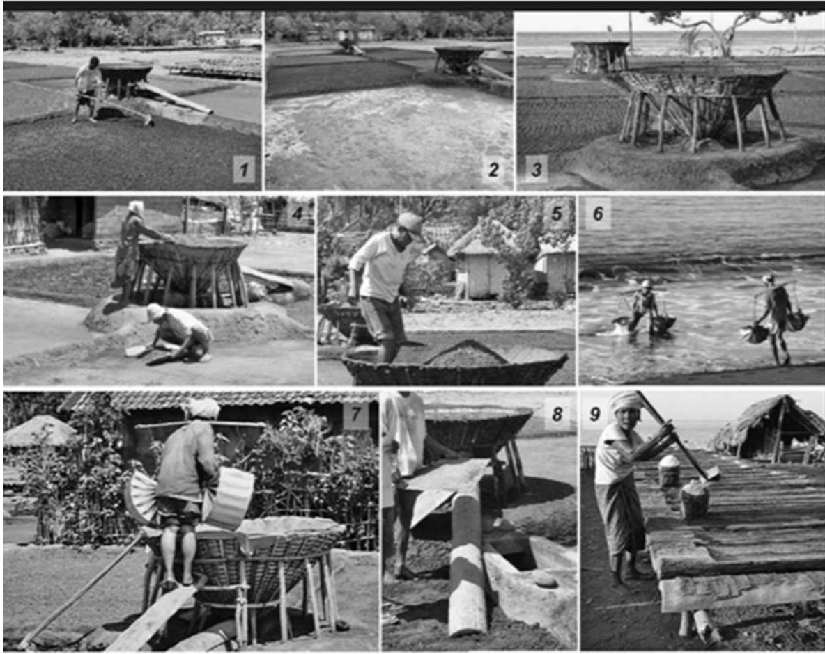
Fig. 9 - La production du sel marin sur la côte orientale de Bali, à Amed (Indonésie). 1- Le sable en haut de la plage est ratisé ; 2- Le sable retourné est saturé avec de l'eau de mer ; 3- Les paniers de filtration sont plantés à l'angle de 4 parcs ; 4- Récolte des sablons et versement dans les paniers ; 5- Le sable est tassé ; 6- Nouveaux va-et-vient vers le rivage pour puiser l'eau ; 7- Versement de l'eau de mer sur les sablons ; 8- L'eau filtrée et concentrée descend dans une fosse creusée dans le sol, ici aménagée pour être puisée sur le côté ; 9- La saumure cristallisée au soleil dans des demi-troncs d'arbre est récoltée à l'aide d'un raclor et d'une pelle (photos J. Daddy et S. Cassen).
