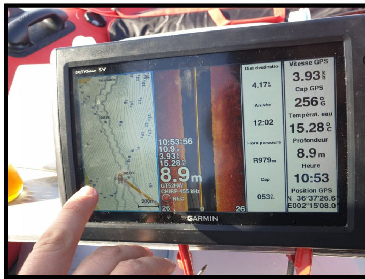
الصورة 09: شاشة الجهاز EchoMapGarmin.
