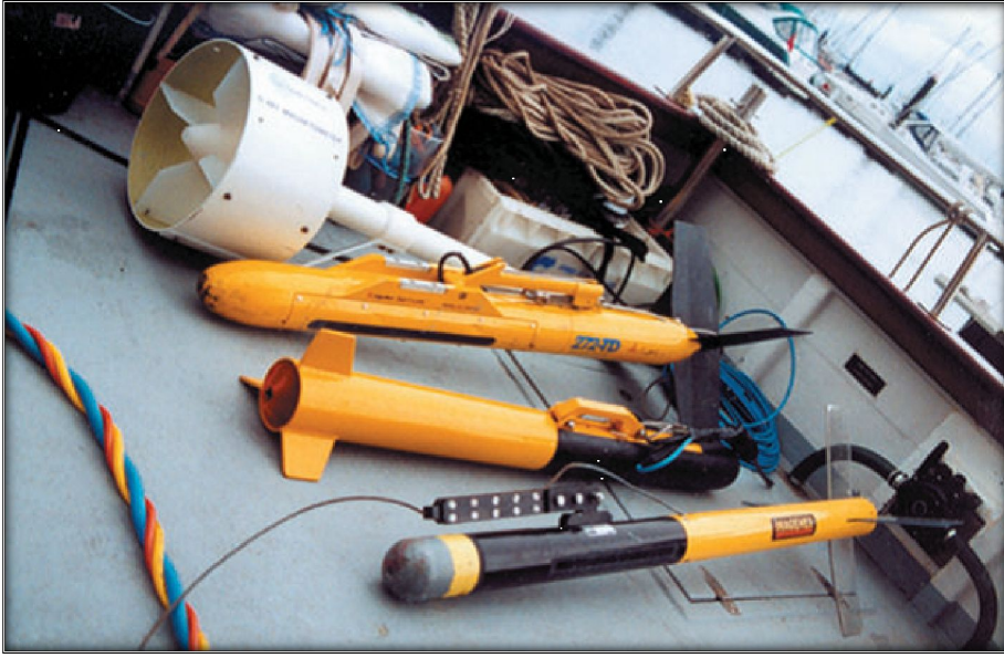
الصورة 01: مختلف الأجهزة الصوتية المستعملة في التحري تحت مائي عن Nautical Archaeology Society, 2009
