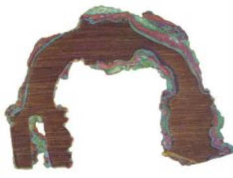
الصورة رقم 03 : مقطع طولي يبين تموضع طبقات نواتج التآكل المصدر: Gettens, R.J. 1970, p. 72 (بتصرف)
