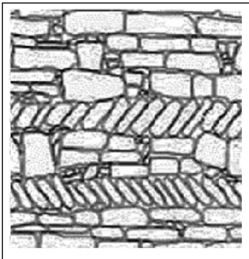
الشكل رقم (06): تقنية المداميك المائلة
