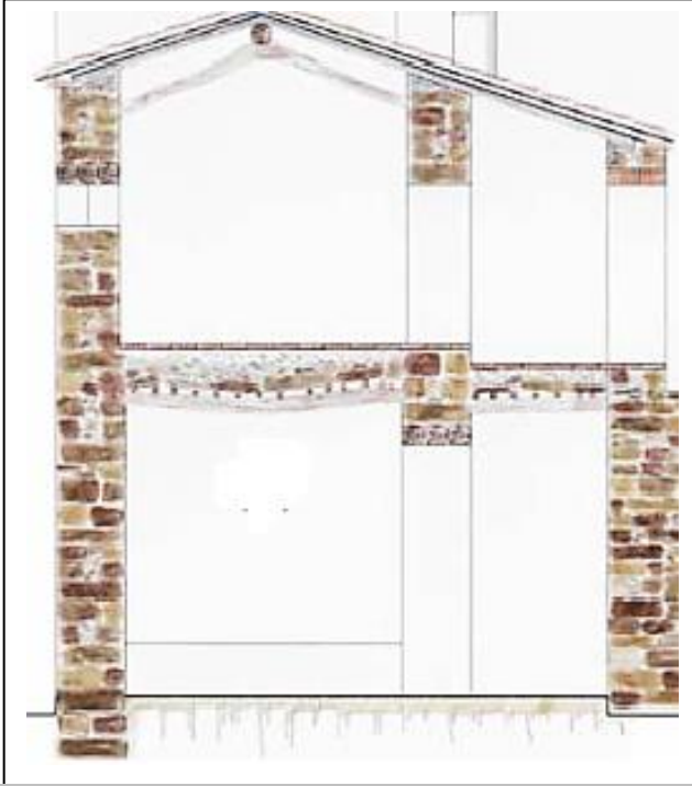
الشكل رقم(11): مقطع طولي في مسكن ذو طابق أرضي وعلوي (سقف مسطح ثم سقف جمالوني)
