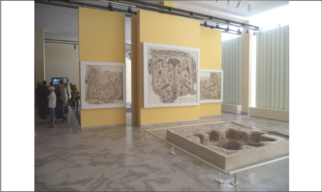
الصورة رقم 51: نظام تثبيت الفسيفساء على جدران منفصلة في المتاحف (سوسة -تونس-) عن الطالب.
