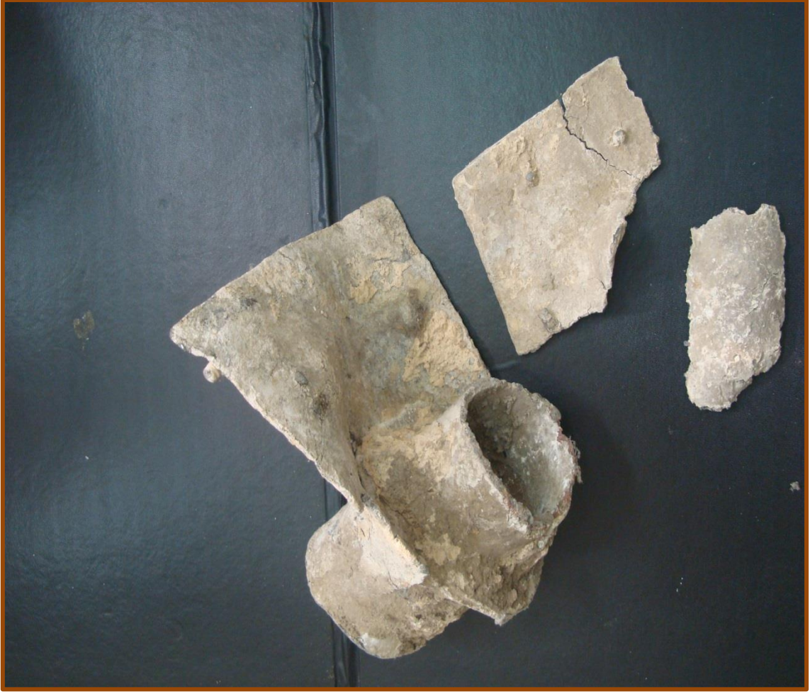
الصورة 26: قناة الناقله للمياه من مادة الرصاص. عن الطالبة
