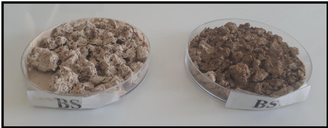
الصورة(51): عينتين من ملاط التراب الواقع في الواجهة الجنوبية بعد تأثرهما بالمحلول الحمضي والقاعدي (بعد مرور 10 أيام).
