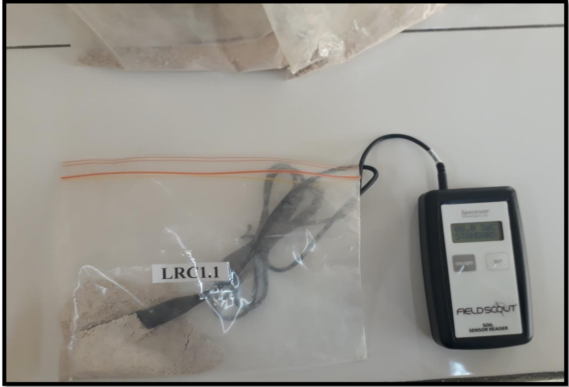
الصورة(37): قياس الرطوبة لإحدى العينات بجهاز (Hygromère)
