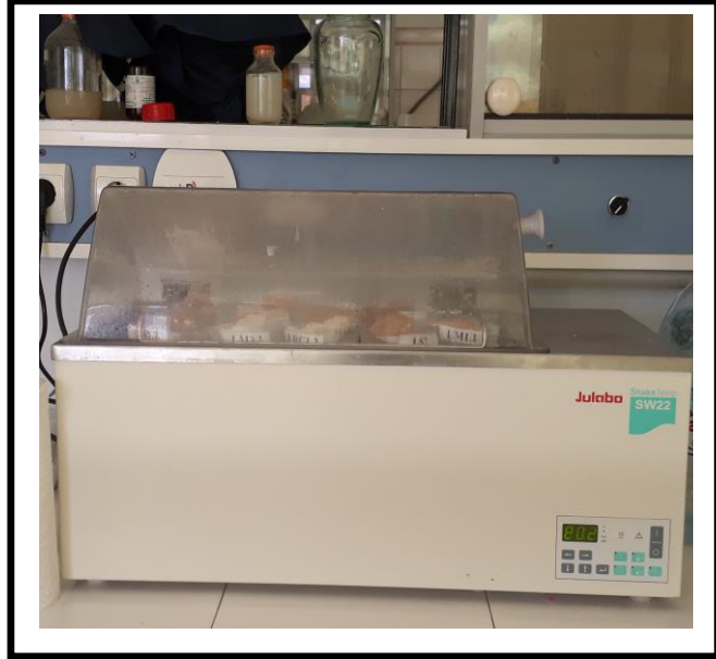
الصورة (40-41): إدخال العينات في جهاز الحمام المائي درجته 80م°
