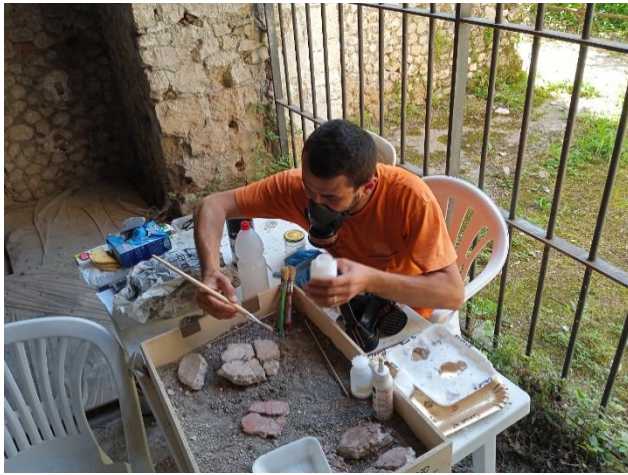
صورة42: أثناء عملية إزالة الشاش على سطح الواجهة الملاطية، والتنظيف الدقيق للواجهة من آثار البارالويد B72، باستعمال الأستون AC33. المصدر: عن الطالب.
