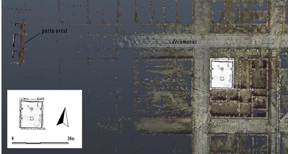
شكل 42: معالجة السحب النقطية للمسح التصويري بطريقة الصور الغرامترية، تظهر المخزن والمستودع "أ"، وقوس النصر الى اليسار، المصدر: عن . Fr. Martorella, 2020 .
