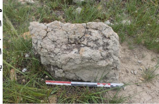
صورة 36: تفتت الحجارة الكلسية في شكل مسحوق، عينة بموقع القلعة البيزنطية، عن الطالب في 2018/05/05.
