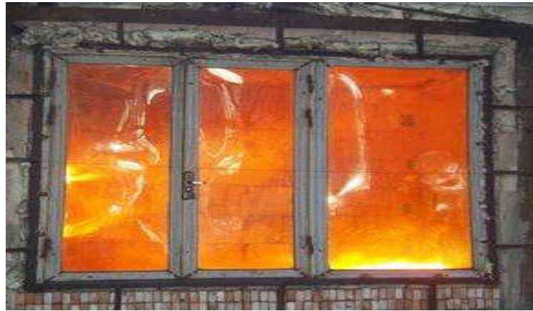
صورة 127: نموذج لزجاج مقاوم للحريق عالي البورسليكات.
