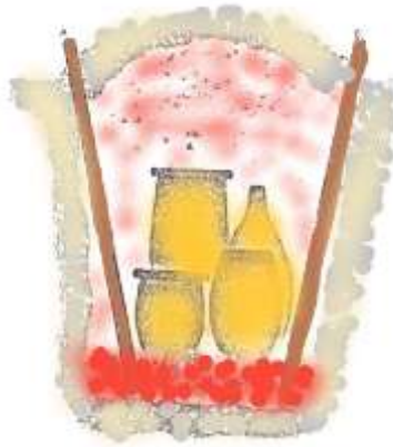
الصورة رقم 11: حرق الأواني الفخارية داخل الحفرة وسدها بطبقة
