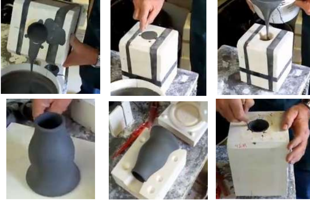
الصورة رقم 06: تشكيل الأواني الفخارية بتقنية القولبة بالصب.
