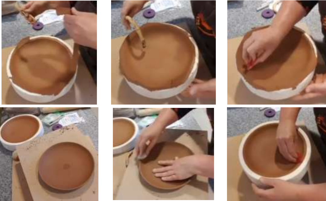
الصورة رقم 05: تشكيل الأواني الفخارية بتقنية القولية بالضغط.
