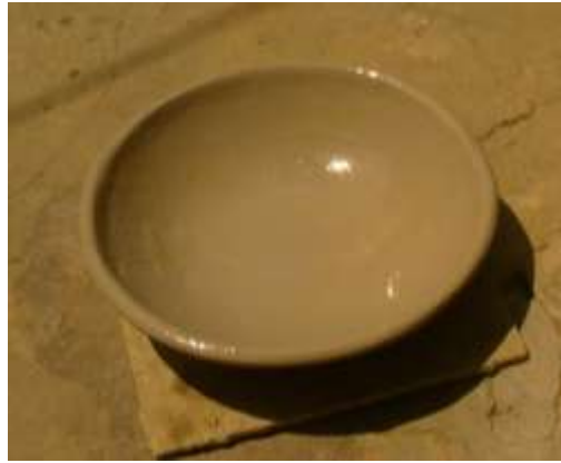
الصورة رقم 33: التجفيف الطبيعي للأواني الفخارية المشكّلة - عن بوردوز وجلويد-
