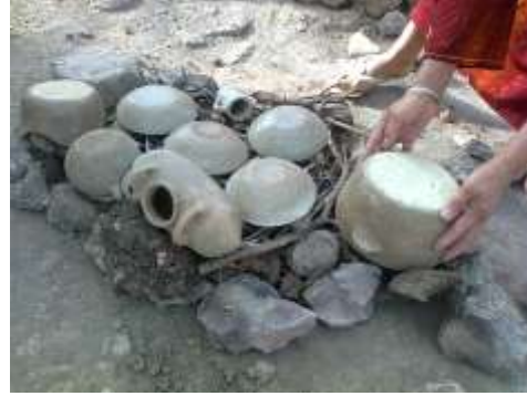
الصورة رقم 37: حرق الأواني الفخارية في الهواء الطلق.
