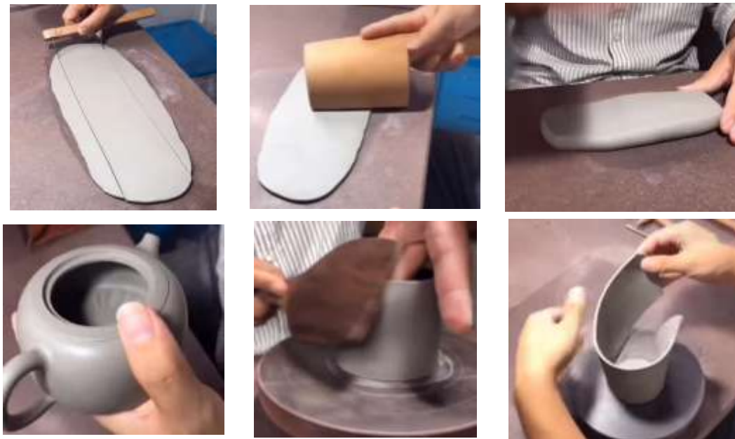
الصورة رقم 02: تشكيل الأواني الفخارية بالصفائح الطينية
