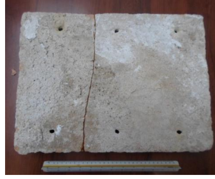
صورة رقم 728 و 729: قرميد مسطح بمتحف كويكول تحتوي على لست ثقوب
