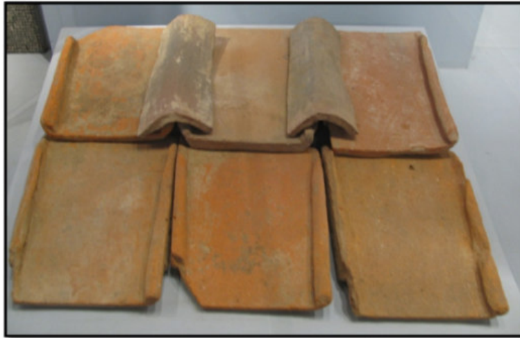
الصورة 59 أشكال قطع القرميد و أسلوب تركيبها .
