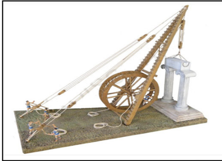
الشكل 31 الآلة الرافعة ذات الساريتين المَزودة بالعجلة
