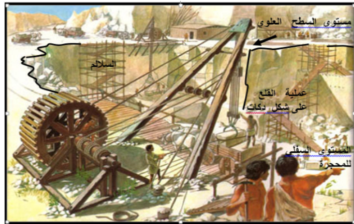
الشكل 01: محجرة على الهواء الطلق تحت سطح الأرض
