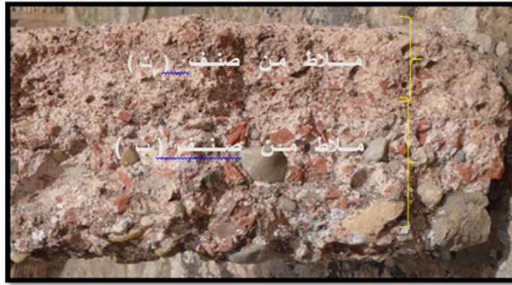
الصورة 54 صنفى الملاط ب و ت ملتحمين في نفس الكتلة عن الطالب
