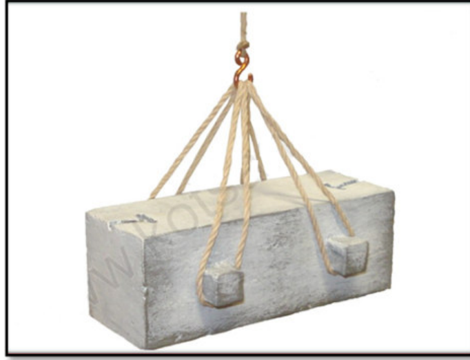
الشكل 34 نظام الرفع بواسطة النتوءات البارزة
