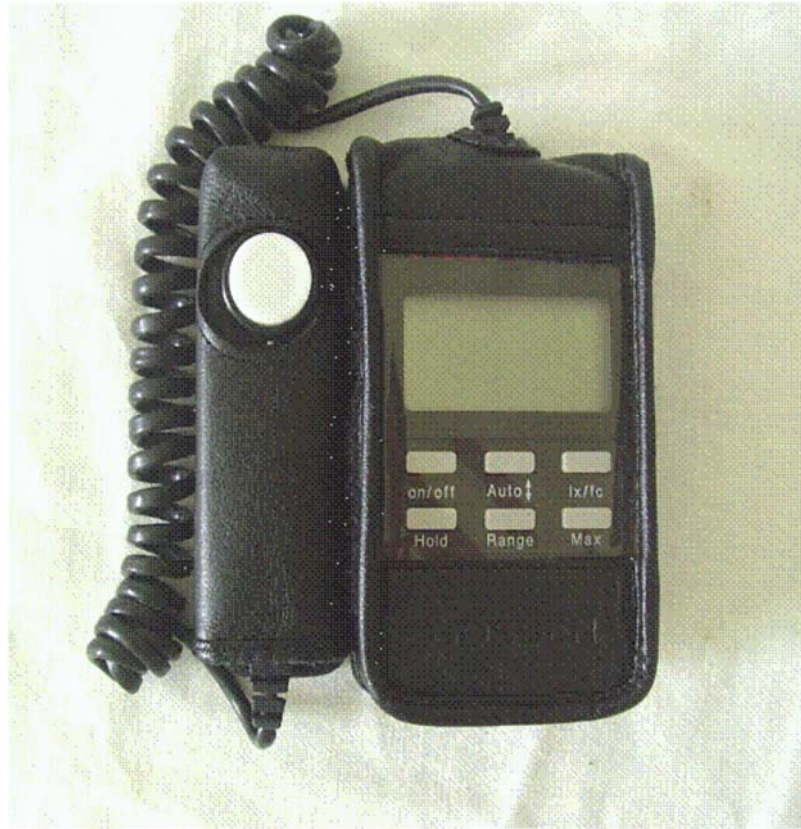
الصورة رقم 8: جهاز اللوكس متر لقياس كمية الضوء
